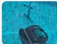
**Click-Up™:** Mit Hilfe des Sensors klettert der Dolphin an der Wand hoch für eine einfache Entnahme aus dem Pool
