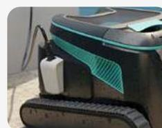
Conductive Charger: Schnelleres Laden als bei induktiver Variante
