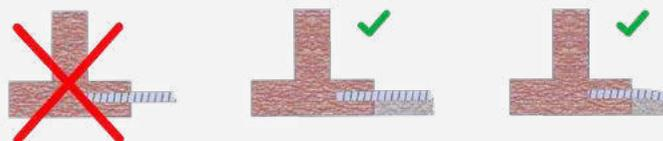
Schlauch nicht unter Spannung montieren (auf Biegeradius achten!)
